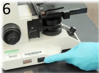
6 Desligue o microscópio no botão da máquina e na fonte de alimentação.
