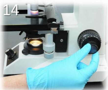
Olhe através das oculares e use o micrométrico para focar a imagem.
