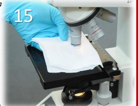
Uma vez terminada a observação, retire a lâmina e limpe o óleo da objetiva de imersão. Utilize apenas o pano exclusivo para limpeza de lentes de microscópio.
