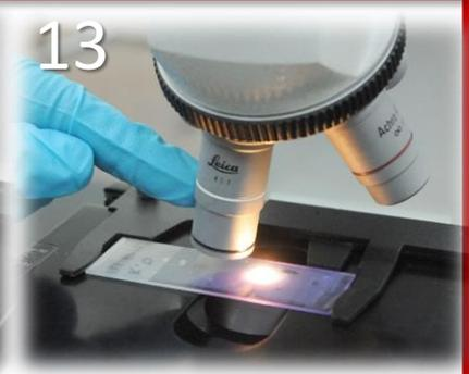
Coloque a objetiva de imersão de óleo no lugar, tendo o cuidado de não entrar em contacto com a lâmina. Se o foco tiver sido alcançado em objectivas de menor potência, a objetiva de imersão em óleo deve deslizar para o seu lugar sem percalços. Quaisquer outros ajustes devem ser feitos através do botão micrométrico.
