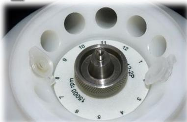
Coloque o tubo na centrífuga. Seja qual for o tipo e o tamanho da centrífuga, lembre-se de equilibrá-la corretamente (colocar um tubo no lado oposto ao tubo de urina) e fixe a tampa.
