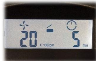
Centrifugue a amostra durante 5 minutos a 450g (aproximadamente equivalente a 1500-2000 rpm, dependendo da centrífuga utilizada).
