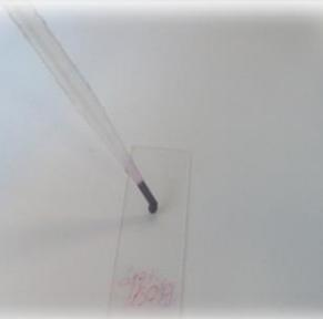
Utilize uma pipeta para transferir uma gota do sedimento reconstituído para uma lâmina de microscópio.
