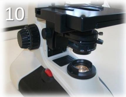
Coloque a lâmina e lamela no microscópio e faça o exame utilizando em primeiro lugar a lente de baixa potência (x10) e depois a lente de alta potência (x40).
