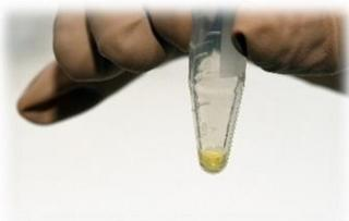
Quando a centrífuga tiver parado, remova o tubo. Remova o sobrenadante (fluido livre no topo da amostra) com uma pipeta de plástico ou por decantação.
