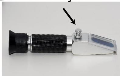
Para calibrar o refratômetro, em primeiro lugar assegure-se que este está limpo. Limpe a superfície com um pano limpo e água destilada.
