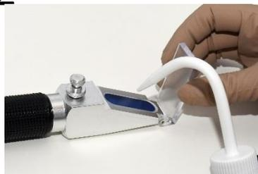
Coloque um pequeno volume (uma ou duas gotas) de água destilada sobre a superfície de leitura e feche a tampa.
