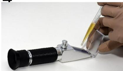
Limpe a água da placa de leitura com um pano limpo, de forma a assegurar que a urina não será inadvertidamente diluída, afetando os resultados. Inverta suavemente a amostra de urina (dentro do contentor de recolha) e coloque uma ou duas gotas sobre a superfície de leitura utilizando uma seringa limpa. Inverter a urina permite homogeneizar a amostra, garantindo uma leitura com mais precisão.
