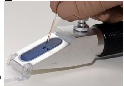
Coloque a extremidade do fragmento que contém o plasma na superfície do refratômetro.
