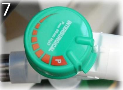
Com a extremidade do tubo ainda coberta, abra a válvula APL rodando-a no sentido contrário ao dos ponteiros do relógio. Isto define a válvula para “baixa pressão”, o que significa que o gás no sistema de respiração escapará/sairá para o sistema de exaustão.
