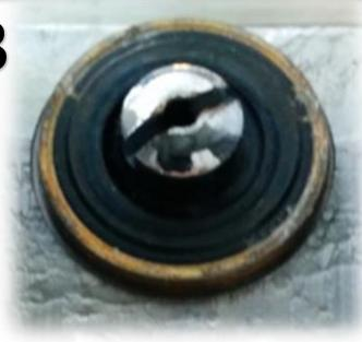
A válvula contém um selo *Bodok*. O selo *Bodok* consiste numa anilha de neopreno (não inflamável) com um anel de cobre.
